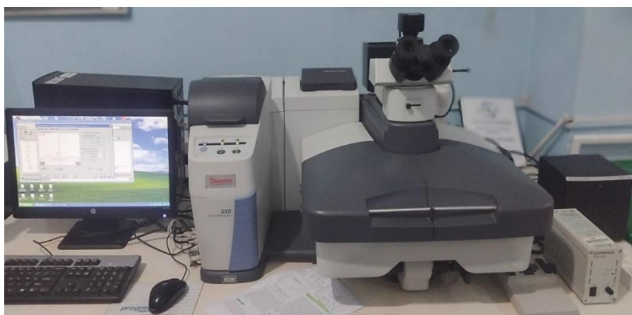
Figure 9 : Système Raman à excitation 532 nm, avec ces accessoires. (Photo personnelle)
