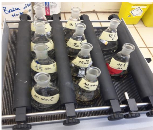
Figure 27 : Traitement physique de l'effluent avec le charbon actif encapsulé. (Photo personnelle)
