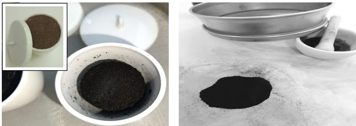
Figure 32 : le charbon actif : (a) après activation chimique, (b) après broyage. (Photo personnelle)
