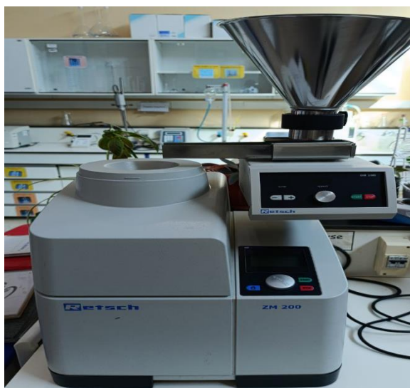
Figure 4 : Broyeur ultra-centrifuge Retsch ZM 200. (Photo personnelle)
