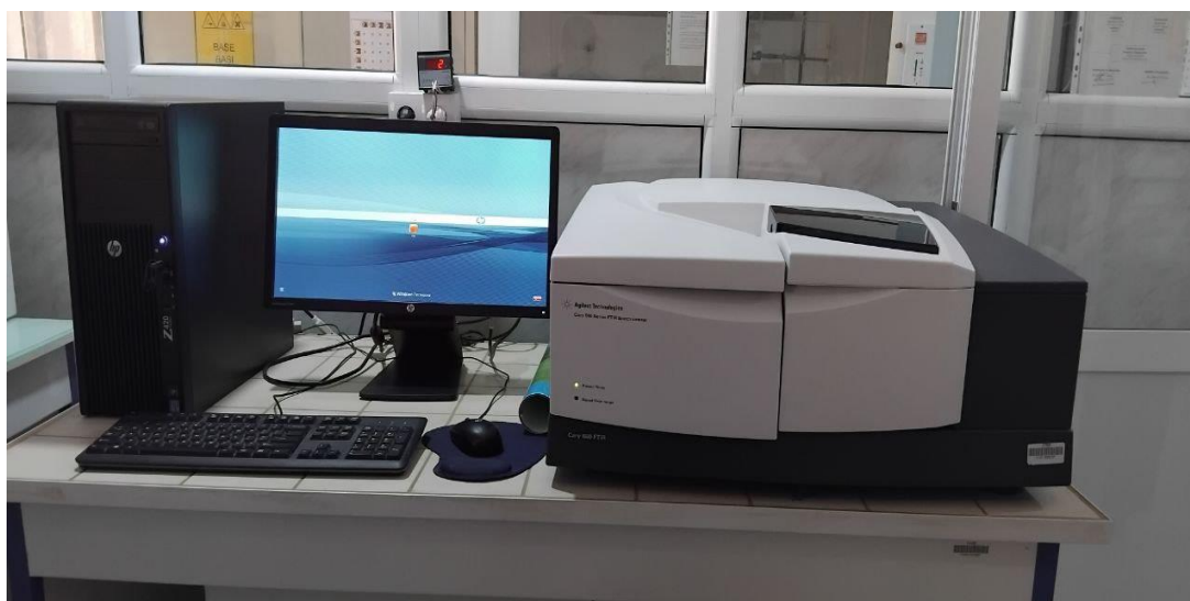
Figure 10 : spectroscopie infrarouge à transformée de Fourier en mode ATR (ATR-FTIR). (Photo personnelle)
