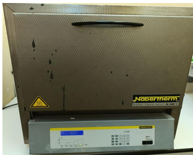
Figure 8 : Four à moufle (Nabertherm). (Photo personnelle)
