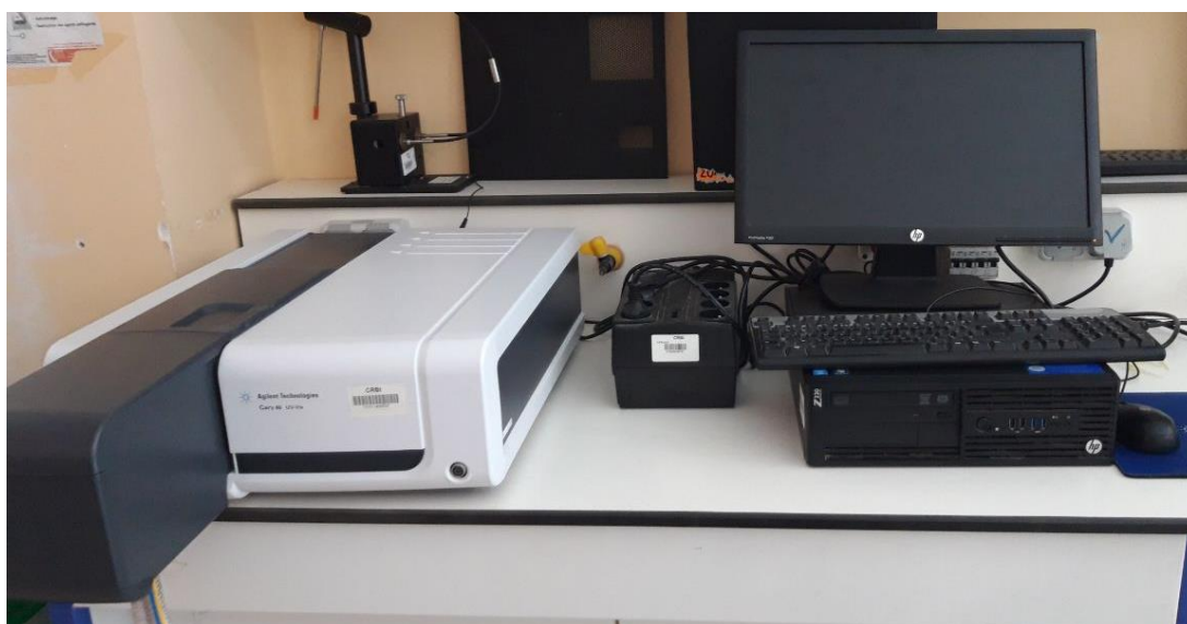
Figure 15 : Spectrophotomètre à balayage (Agilent technologies. Cary 60 UV-Vis). (Photo personnelle)
