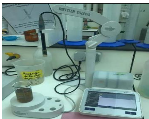
Figure 5 : pH mètre de type Seven Excellence. (Photo personnelle)
