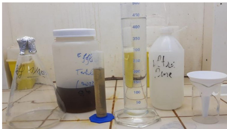
Figure 26 : Préparation de dilution 1/10 de l'effluent. (Photo personnelle)
