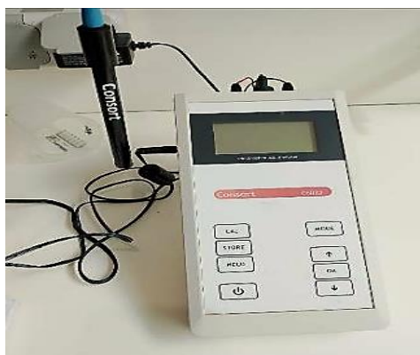
Figure 6 : Multi-paramètres de type Consort (C6030). (Photo personnelle)
