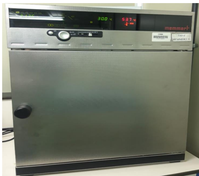
Figure 1 : étuve de laboratoire (memmert). (Photo personnelle)
