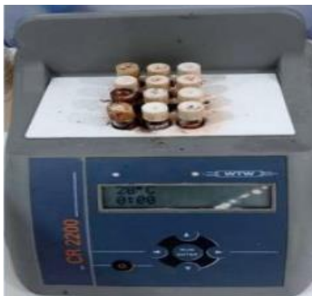
Figure 30 : Bloc chauffant (WTW CR2200). (Photo personnelle)
